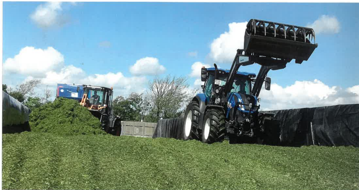
Når ensilagen bliver for tør, kan det være svært at køre stakken hårdt nok sammen. Den manglende komprimering af ensilagen kan gå ud over ensileringsprocessen, påpeger virksomhedsrådgiver Mette Thorhaug. Foto: Mette Iversen.
